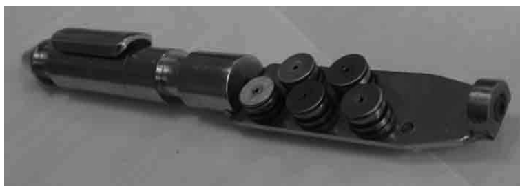
Рисунок 5 – Приспособление для правки и монтажа термометра в дополнительный канал
