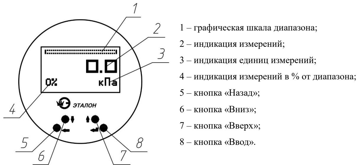
Рисунок 3.2 Жидкокристаллическое устройство индикации.
